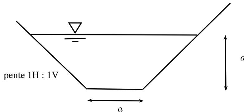
Figure 1 : canal trapézoïdal.
