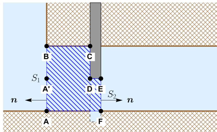
**Figure 1** – Pour la question (7), on considère le volume de contrôle reporté en hachuré de largeur  $\ell$  et de pourtour ABCDEF. La section entrante est  $S_1$ , et la section sortante est  $S_2$ .
