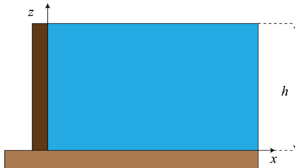
Figure 3 : seuil droit de barrage.
