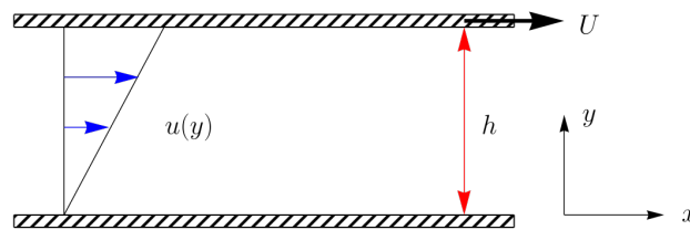
Figure 1.8 – Cisaillement d'un fluide entre deux plaques parallèles espacées d'une distance h ; la plaque supérieure se déplace à la vitesse U .
