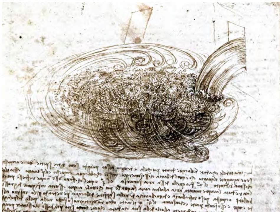
Figure 5 – Étude par Léonard de Vinci d'un écoulement d'eau au passage d'obstacles (vers 1508). « Observe le mouvement de l'eau à sa surface, combien il ressemble à celui de la chevelure, laquelle en a deux, l'un suivant l'ondulation de la surface, l'autre les lignes des courbures ; ainsi, l'eau forme des tourbillons qui suivent en partie l'impulsion du courant principal, et en partie les mouvements ascendants et incidents. » (Carnets, chap. XXI, de la nature de l'eau).
